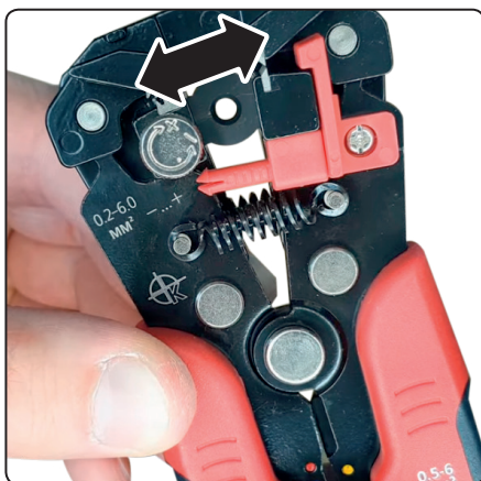
Obr. C - Stahování izolace kabelu čelistmi Obr. C - Stahování izolace kabelu čelistmi Obr. C - Stahování izolace kabelu čelistmi Obr. C - Stahování izolace kabelu čelistmi Obr. C - Stahování izolace kabelu čelistmi
